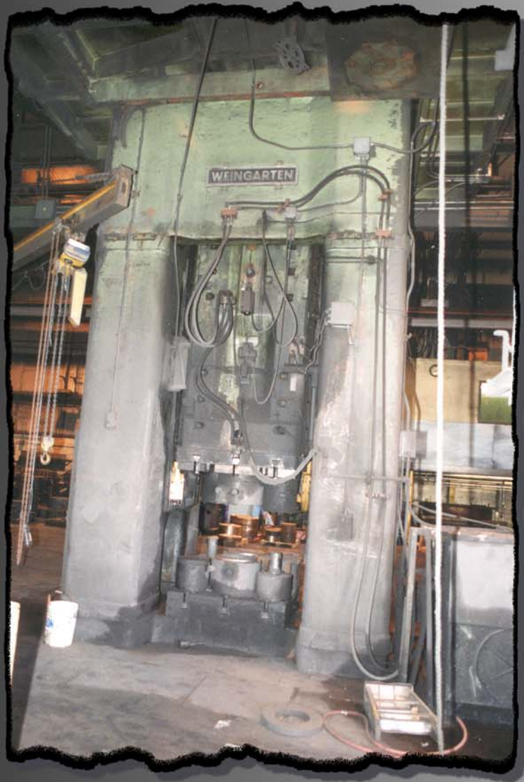
5000 Ton Weingarten Screw Press Model PSR 560 Mfg. 1979
