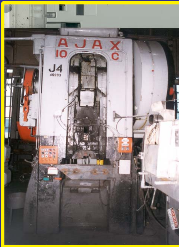
1000 Ton Ajax Forging Press Mfg. 1953, SN 4615
